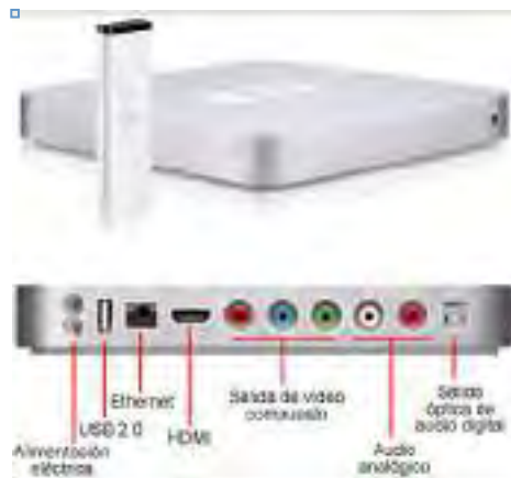
Figura 1. Vista frontal, trasera y mando a distancia de la Apple Tv de primera generación.
