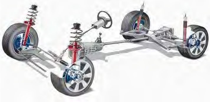
Figura 5: Función de los amortiguadores
