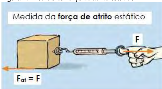
Figura 4: Medida da força de atrito estático
